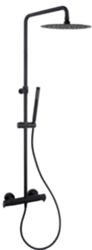
Columna telescópica termostática con inersor: integrado, rociador metálico 250 mm. Ø. Caudal a 3 bar: 12 l/min en salida teleducha y 16 l/min en salida rociador.
