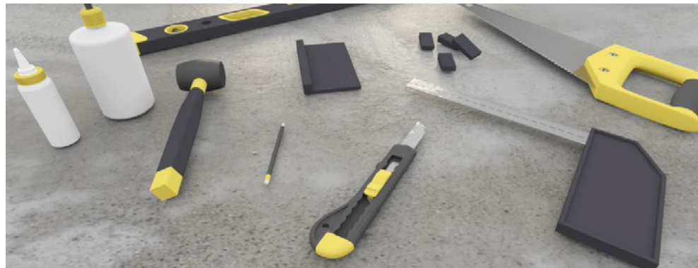
Herramientas: espaciadores, martillo de goma, regla, lápiz, metro, cúter, taco de goma, pegamento de vinilo premium y aguarrás. / Tools: spacers, rubber mallet, ruler, pencil, tape measure, utility knife, tapping block, premium vinyl adhesive and mineral spirits.
